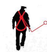
Caída FACTOR 1 punto de anclaje situado al mismo nivel del punto de anclaje dorsal del arnés
