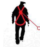
Caduta FATTORE 2 il punto di ancoraggio è situato sotto il punto di ancoraggio dorsale dell'imbracatura
