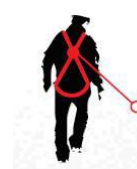
Caída FACTOR 2 el punto de anclaje situado bajo la conexión dorsal del arnés
