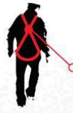
Queda FATOR 2 ponto de ancoragem situado a baixo da conexão dorsal do arnês
